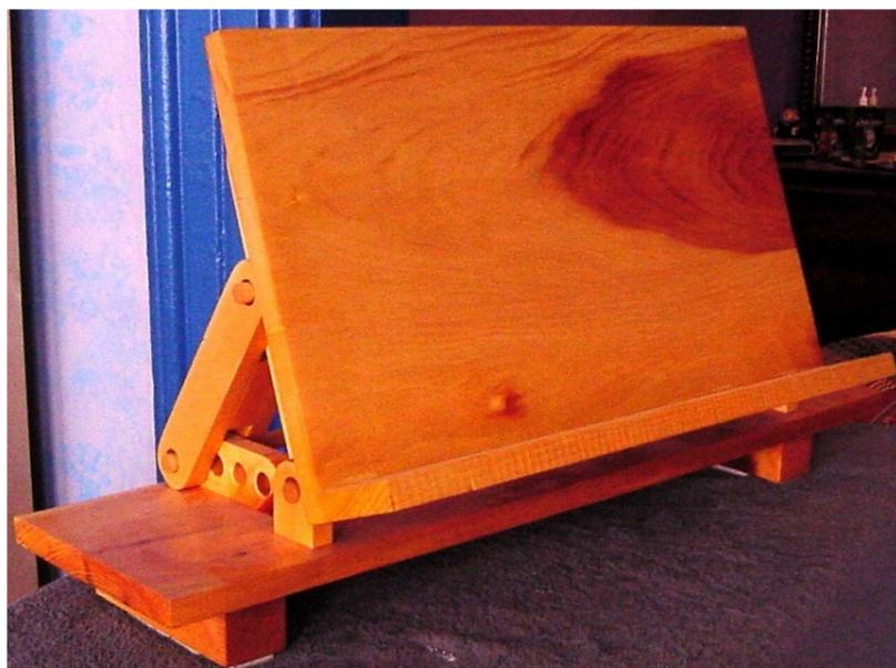
En casi todos los hogares existen ejemplos de este mecanismo. Uno de ellos se emplea para mantener más o menos abierta la ventana. La barra de sujeción tiene varios agujeros, permitiendo fijarla en diversas posiciones a un pasador fijo al marco. Al variar la longitud de la barra, la ventana se abre un ángulo más o menos grande. Un mecanismo muy parecido permite ajustar el tablero de las mesas de delineación en el ángulo más adecuado, o graduar la apertura de las ventanas de los invernaderos.
