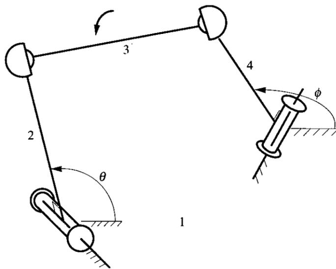
Imagen 3.4. Un mecanismo espacial formado por cuatro componentes y cuatro pares. Dos de los pares son giratorios. Los otros dos son pares esféricos.  $\theta$  es el ángulo de entrada y  $\phi$  es el ángulo de salida. El mecanismo tiene un grado de libertad inútil ya que el componente 3 puede girar alrededor de la línea que une los centros de los pares esféricos sin tener ningún efecto sobre la relación entre  $\theta$  y  $\phi$ .
