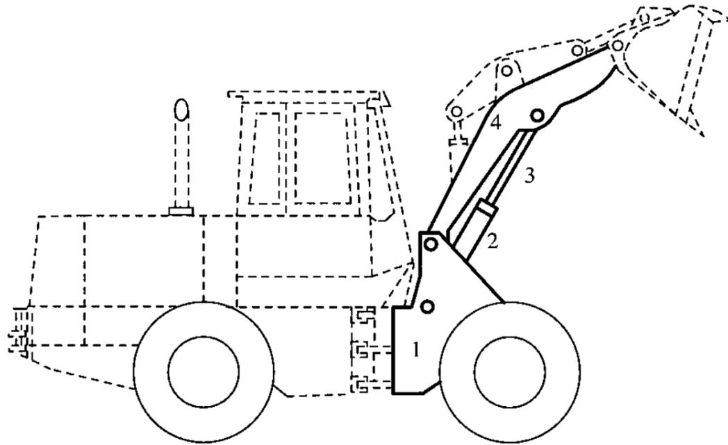
Imagen 3.11. Esquema del mecanismo de soporte derecho de la cuchara para la cargadora frontal de la Fig. 4.
