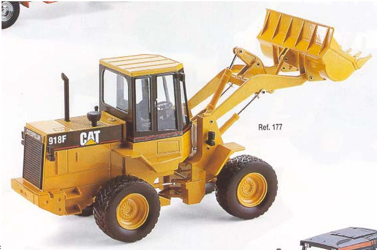
Imagen 3.10. Cargadora frontal. Si se analiza utilizando las ecuaciones de movilidad para mecanismos planos, resulta que se obtiene un número de grados de libertad inferior a uno. Se utilizan actuadores paralelos en ambos lados de la máquina para equilibrar la carga e incrementar la rigidez. La parte correspondiente al control de la cuchara tiene dos grados de libertad.
