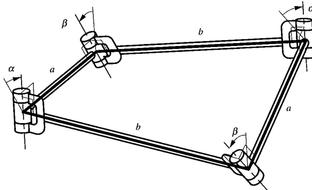
Imagen 3.8. El mecanismo de Bennett. Las longitudes de sus componentes y los ángulos que forman los ejes de los pares giratorios verifican la relación
