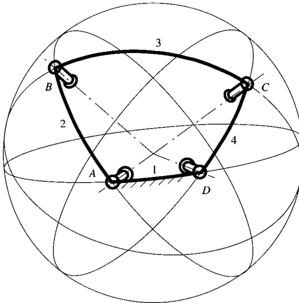
Imagen 3.9. Mecanismo esférico de cuatro componentes.
