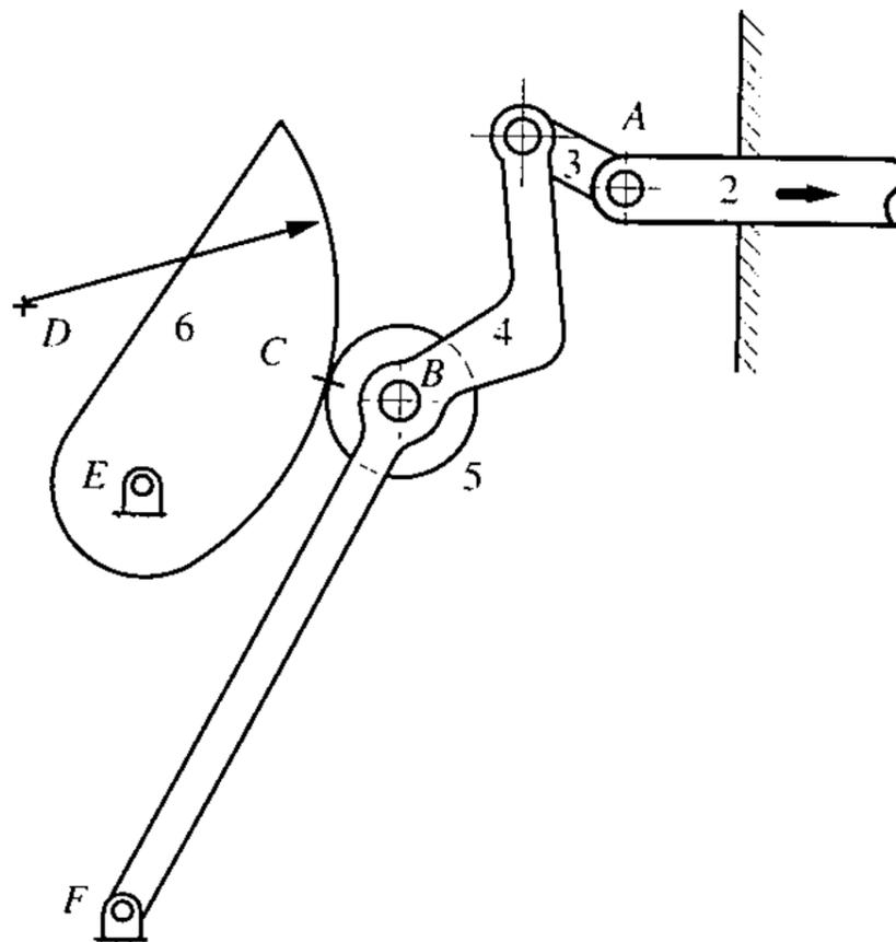
Imagen 3.6. Mecanismo plano con un grado de libertad inútil.
