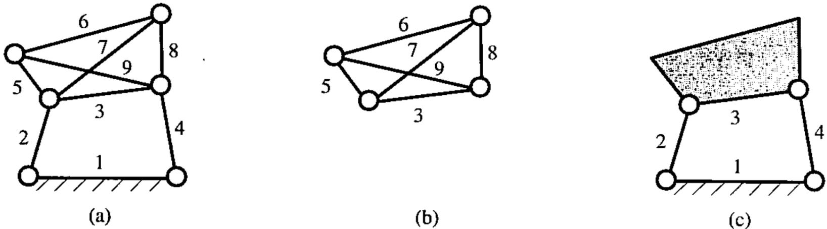
Imagen 3.7. (a) Un mecanismo plano en el que una parte del mismo es una estructura, dando lugar a un cálculo incorrecto de la movilidad al utilizar la ecuación correspondiente a mecanismos planos. Todos los pares son giratorios. (b) Parte del mecanismo que es una estructura estáticamente indeterminada. (c) Modelo modificado del mecanismo con el que se podría utilizar la fórmula para calcular un valor correcto de la movilidad.
