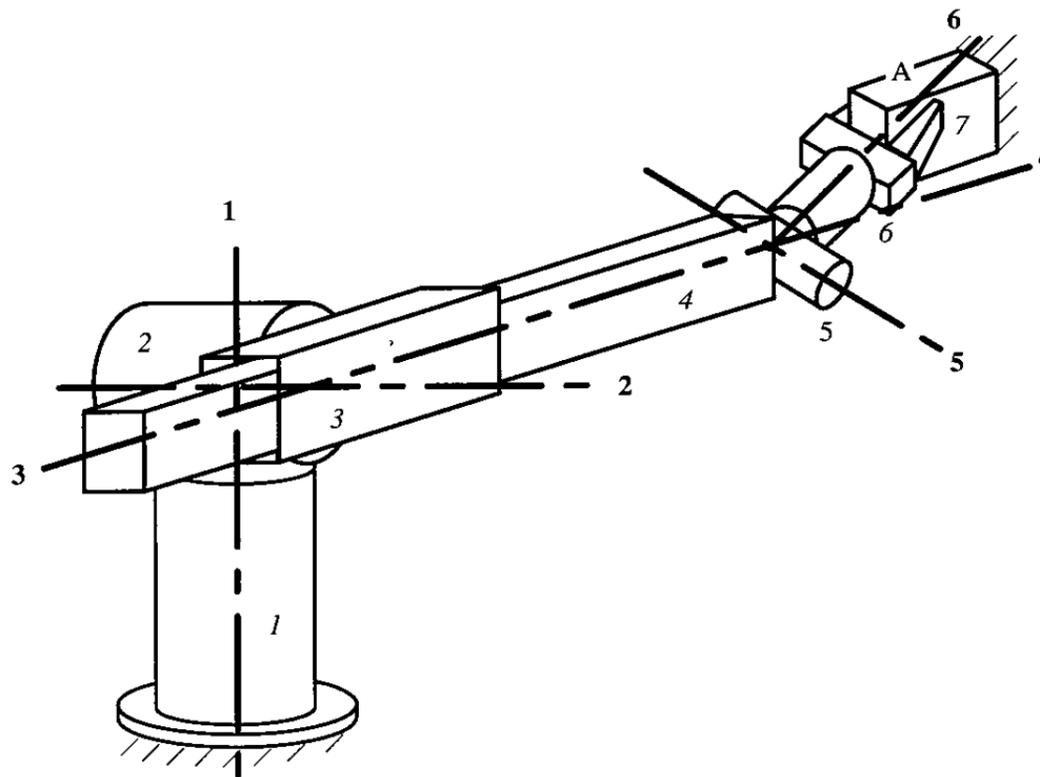
Imagen 3.3. El manipulador robotizado de la Fig. 3 cogiendo un cuerpo fijado a la base. Si la mordaza coge el objeto de tal forma que el movimiento relativo sea imposible, la mordaza resulta fija con el cuerpo base. Esto da como resultado una disminución de los componentes del sistema a seis y crea un lazo cerrado.
