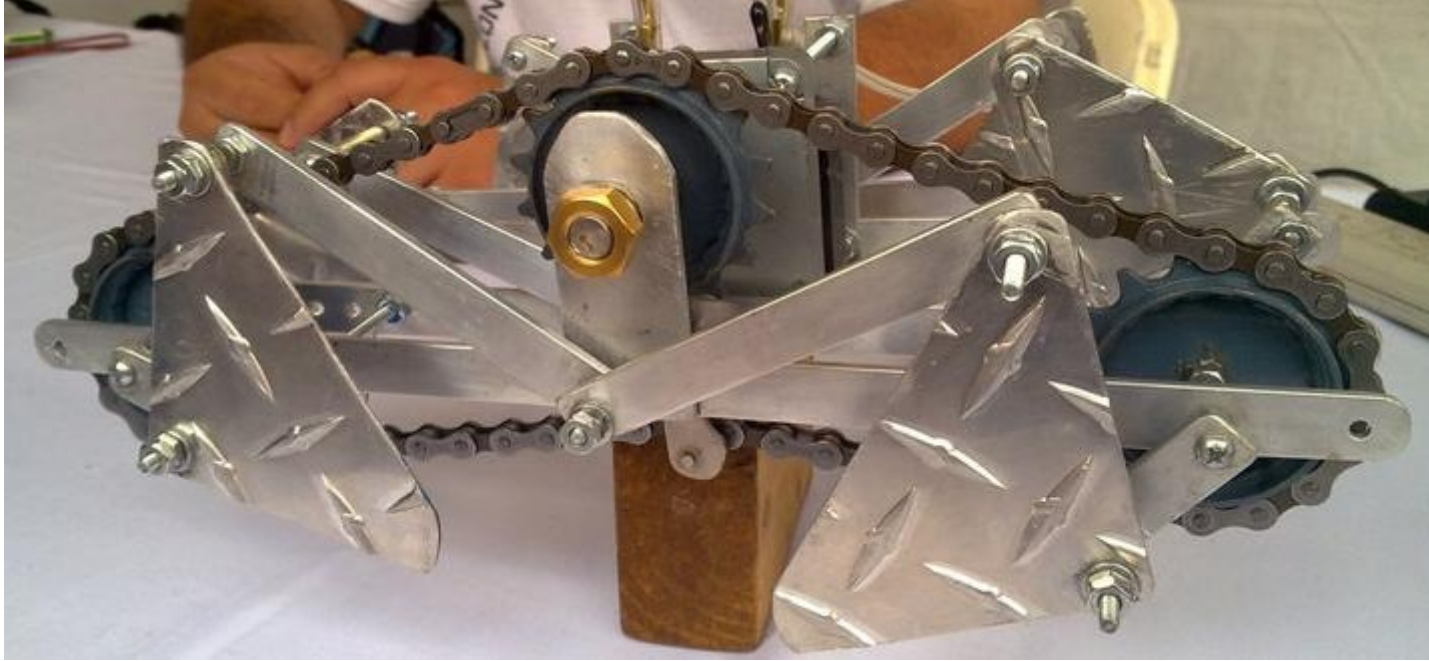
Imagen 2.39. Montaje de un mecanismo obtenido mediante técnicas de síntesis.
