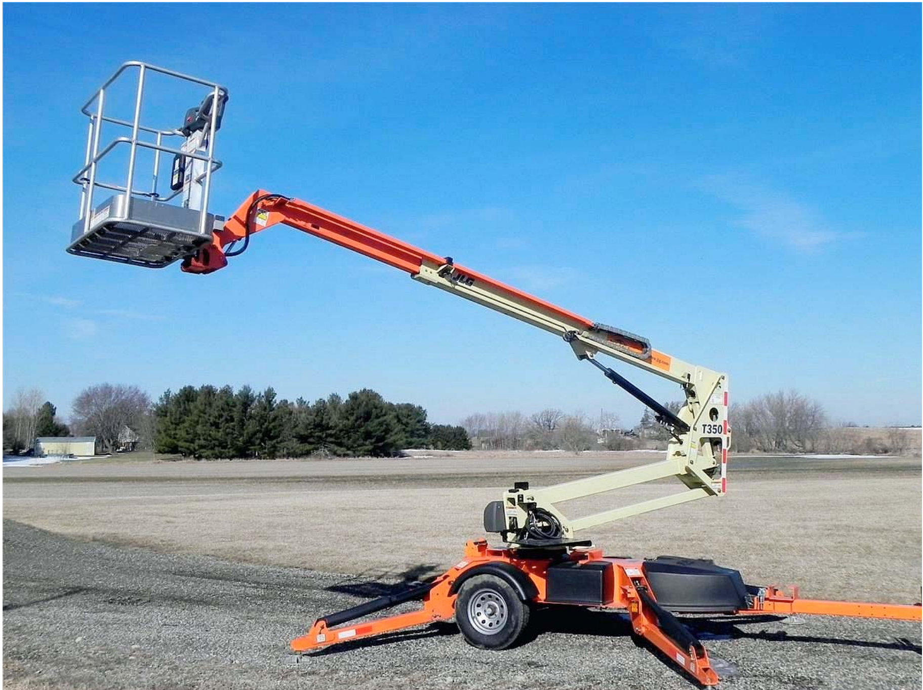
Imagen 2.1. Modelo Real de una Maquinas de Obras Públicas: JLG T-350.
