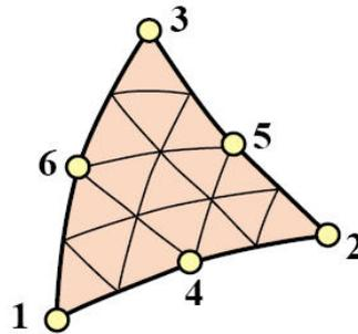
$$\begin{bmatrix} 1 \\ x \\ y \\ u_x \\ u_y \end{bmatrix} = \begin{bmatrix} 1 & 1 & 1 & 1 & 1 & 1 \\ x_1 & x_2 & x_3 & x_4 & x_5 & x_6 \\ y_1 & y_2 & y_3 & y_4 & y_5 & y_6 \\ u_{x1} & u_{x2} & u_{x3} & u_{x4} & u_{x5} & u_{x6} \\ u_{y1} & u_{y2} & u_{y3} & u_{y4} & u_{y5} & u_{y6} \end{bmatrix} \begin{bmatrix} N_1^{(e)} \\ N_2^{(e)} \\ N_3^{(e)} \\ N_4^{(e)} \\ N_5^{(e)} \\ N_6^{(e)} \end{bmatrix}$$
