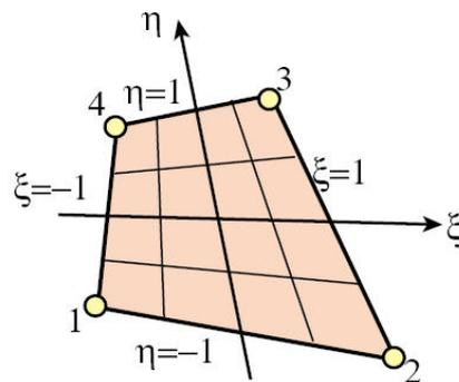
$$\begin{bmatrix} 1 \\ x \\ y \\ u_x \\ u_y \end{bmatrix} = \begin{bmatrix} 1 & 1 & 1 & 1 \\ x_1 & x_2 & x_3 & x_4 \\ y_1 & y_2 & y_3 & y_4 \\ u_{x1} & u_{x2} & u_{x3} & u_{x4} \\ u_{y1} & u_{y2} & u_{y3} & u_{y4} \end{bmatrix} \begin{bmatrix} N_1^{(e)} \\ N_2^{(e)} \\ N_3^{(e)} \\ N_4^{(e)} \end{bmatrix}$$
