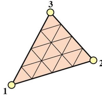
$$\begin{bmatrix} 1 \\ x \\ y \\ u_x \\ u_y \end{bmatrix} = \begin{bmatrix} 1 & 1 & 1 \\ x_1 & x_2 & x_3 \\ y_1 & y_2 & y_3 \\ u_{x1} & u_{x2} & u_{x3} \\ u_{y1} & u_{y2} & u_{y3} \end{bmatrix} \begin{bmatrix} N_1^{(e)} \\ N_2^{(e)} \\ N_3^{(e)} \end{bmatrix}$$
