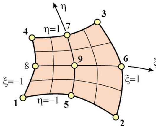
$$\begin{bmatrix} 1 \\ x \\ y \\ u_x \\ u_y \end{bmatrix} = \begin{bmatrix} 1 & 1 & 1 & 1 & 1 & 1 & 1 & 1 & 1 \\ x_1 & x_2 & x_3 & x_4 & x_5 & x_6 & x_7 & x_8 & x_9 \\ y_1 & y_2 & y_3 & y_4 & y_5 & y_6 & y_7 & y_8 & y_9 \\ u_{x1} & u_{x2} & u_{x3} & u_{x4} & u_{x5} & u_{x6} & u_{x7} & u_{x8} & u_{x9} \\ u_{y1} & u_{y2} & u_{y3} & u_{y4} & u_{y5} & u_{y6} & u_{y7} & u_{y8} & u_{y9} \end{bmatrix} \begin{bmatrix} N_1^{(e)} \\ N_2^{(e)} \\ \vdots \\ N_9^{(e)} \end{bmatrix}$$
